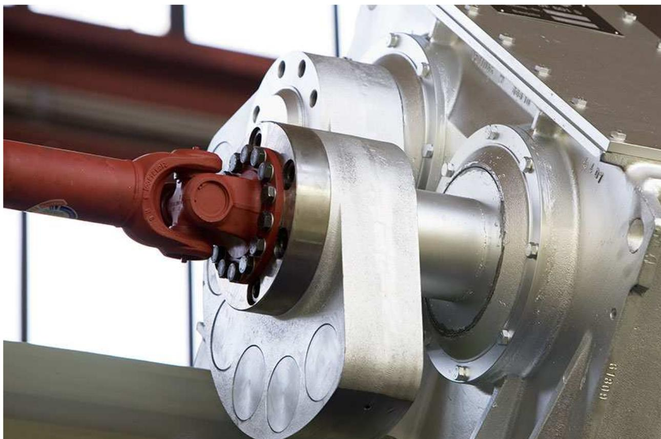
Certifique-se de montar todos os equipamentos de proteção e segurança, em conformidade com os requisitos legais do local da instalação. O limite da temperatura do mecanismo vibratório é de 100°C (212°F). Caso a temperatura de operação seja maior, consulte o fabricante sobre possíveis medidas que possam arrefecer os vibradores.
