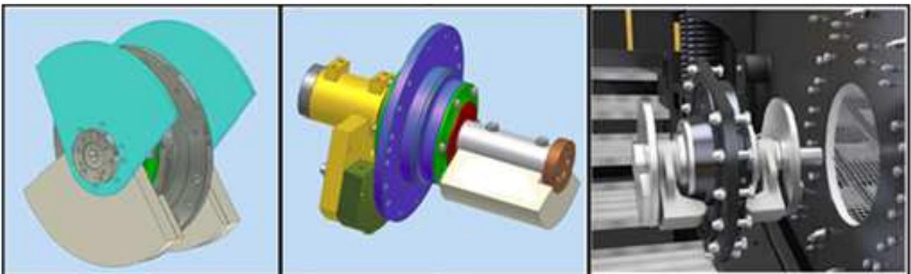
Esse tipo de mecanismos conforme mostrado na foto acima, contém dois rolamentos, lubrificadas independentemente por graxeiras, geralmente localizadas a aproximadamente 180 graus uma da outra. A graxa injetada passa através dos rolamentos, e expulsa a graxa interna pelos labirintos formados entre os flanges dinâmicas e estáticas. A graxa a partir deste ponto é eliminada pelas fendas contidas na proteção dos contrapesos, conforme figura abaixo
