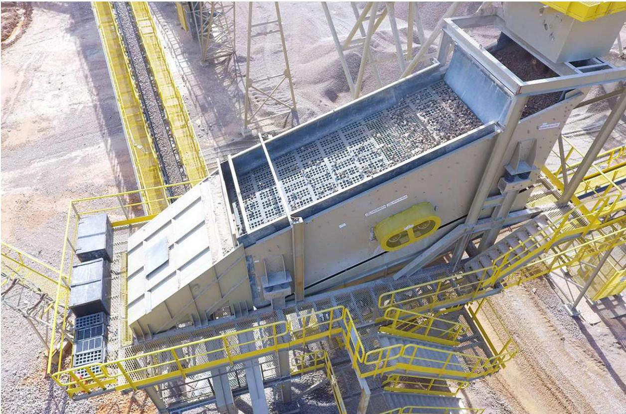
Definir o peneiramento é simples. Trata-se de um processo usado para classificar materiais pelo tamanho de suas partículas: os finos são “aceitos” e passam pela malha das telas e os materiais grossos ficam retidos e seguem para outras etapas. Ponto. Já a especificação do equipamento adequado é uma tarefa para especialistas. Nossa missão, nesse artigo rápido, é destacar os pontos principais e ajudá-lo a entender a linguagem dos técnicos.
