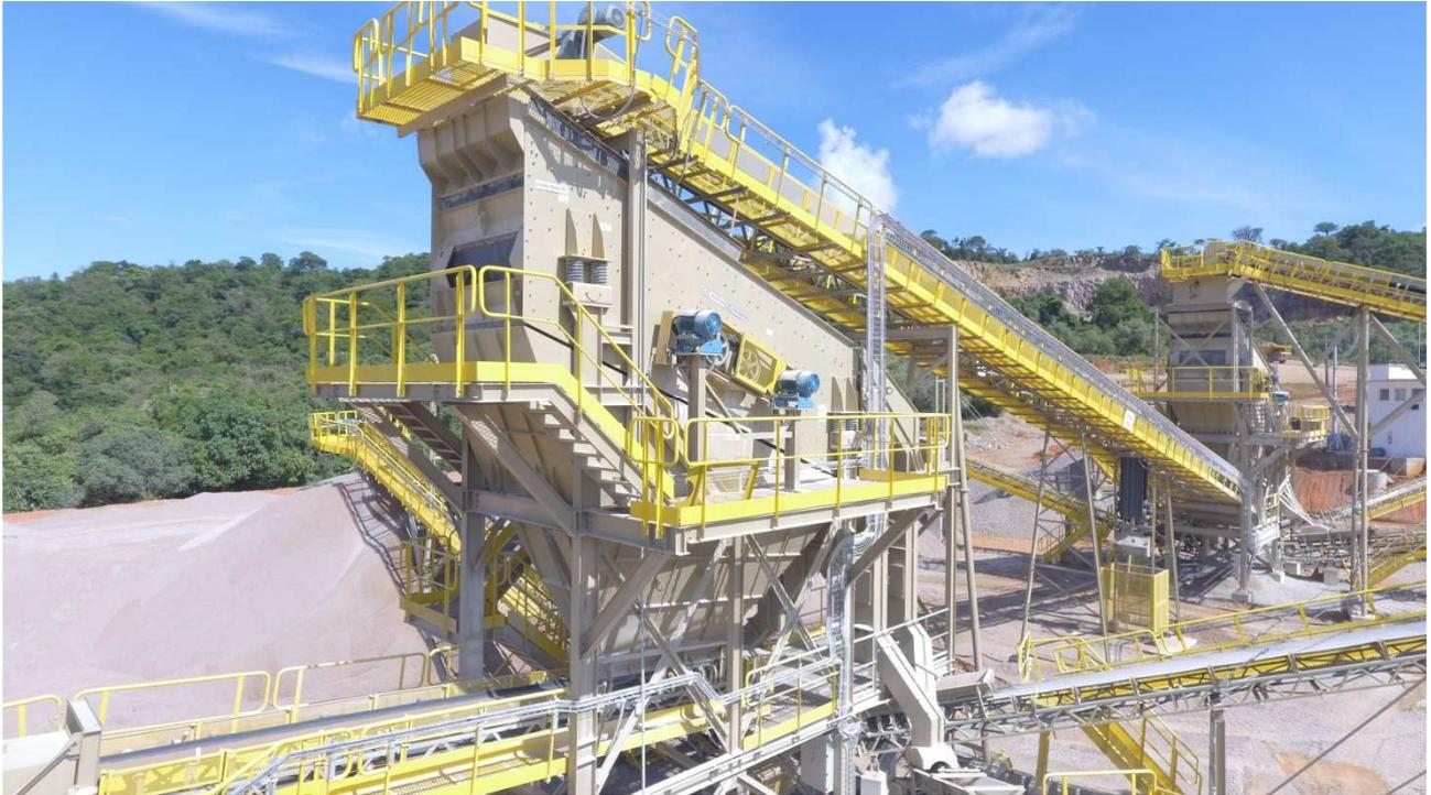
Em todos os casos, uma boa operação começa com a correta instalação do equipamento. E uma correta instalação começa com uma estrutura suporte devidamente projetada para suportar os esforços dinâmicos e estáticos provenientes da peneira. Peneiras maiores devem ter uma base extremamente forte e rígida! Se a estrutura apresentar falta de rigidez, a peneira irá dissipar seu movimento vibrando a estrutura suporte e apresentando diferenças de amplitude e fase entre o lado direito e o esquerdo.
