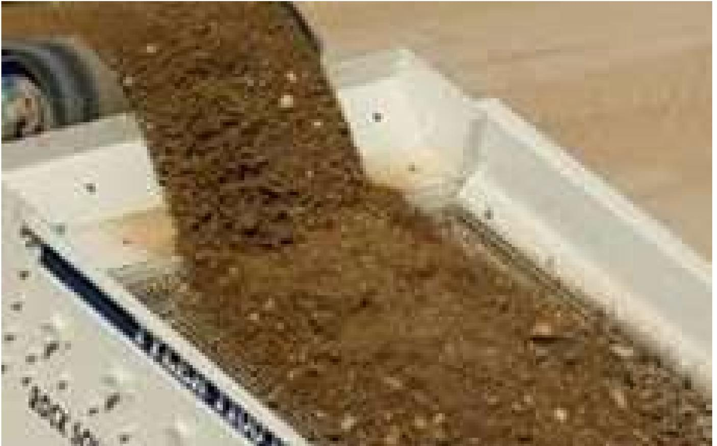
A função das peneiras vibratórias é separar os materiais em frações de tamanhos, evitando a excessiva contaminação de uma fração com partículas pertencentes à outra.
