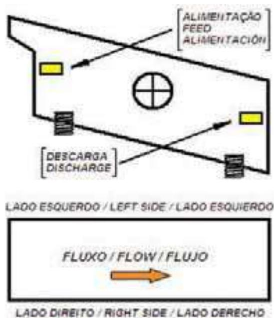
Segure firmemente um lápis ou caneta num apoio e posicione na mesma altura de cada cartão e bem próxima a eles. Com a peneira em operação, toque momentaneamente o cartão em diversos pontos para conseguir os registros da forma do movimento.
