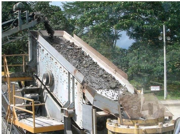
**Caixa de alimentação:** uma extensão da estrutura vibratória na extremidade de alimentação que recebe a alimentação de material.
