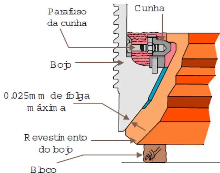
O contato entre a cunha e o revestimento do bojo deve ser feito na posição "inclinada" da cunha.
