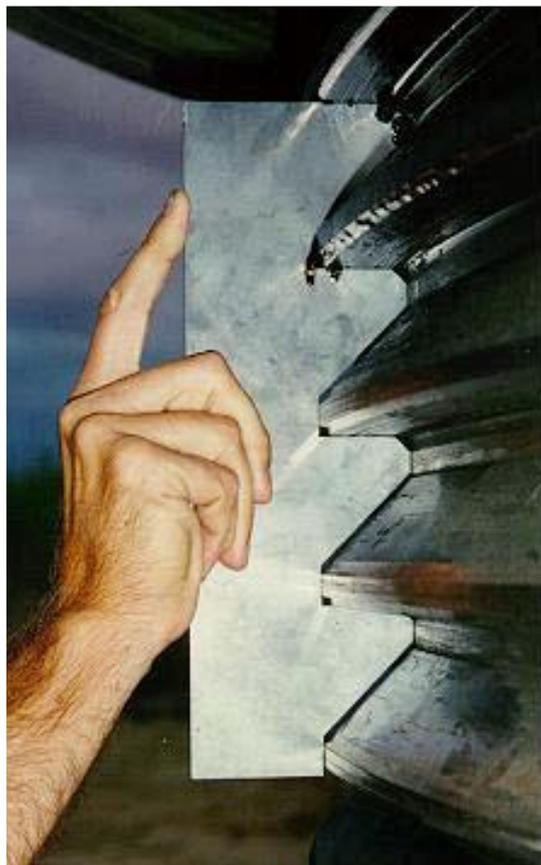
**NOTA:** O desgaste do bojo, anel de ajuste, e anel de travamento da rosca podem ser inspecionadas pelo uso de um gabarito de controle. Segure firme o gabarito plano pela rosca plana e empurre até o quanto for possível. Então meça e grave a falha (se houver) que existe entre a porção cônica do gabarito e pela porção cônica da rosca.
