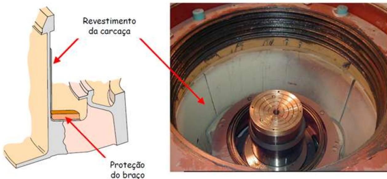
**Nota importante:** O revestimento principal da carcaça principal e as proteções do braço devem ser inspecionados quanto a desgaste periodicamente, pelo menos a cada substituição da manta e revestimento do bojo.
