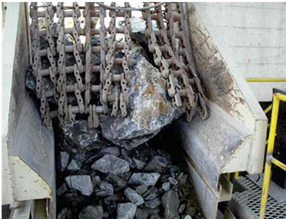
Devido ao risco de soltura destas barreiras, um ponto importante é a correta escolha do tipo e a quantidade de barreiras instaladas. Os pneus inutilizados podem ser outra solução.
