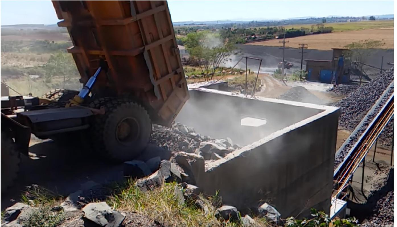
Normalmente, nas instalações com grandes volumes de material processados, é observada a alimentação incorreta dos britadores de mandíbulas, onde o material basculado na tremonha acaba que ganhando uma grande velocidade juntamente com grandes dimensões.
