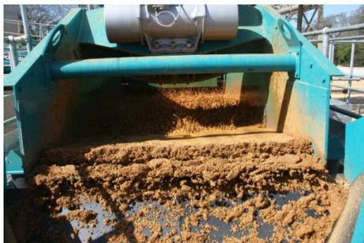
Para aumentar a capacidade de desaguamento, ou seja, para conseguir a máxima compactação (compressão) são colocadas telas também na tampa traseira da peneira de maneira a recolher o máximo de água superficial aumentando assim a capacidade e qualidade de desaguamento.
