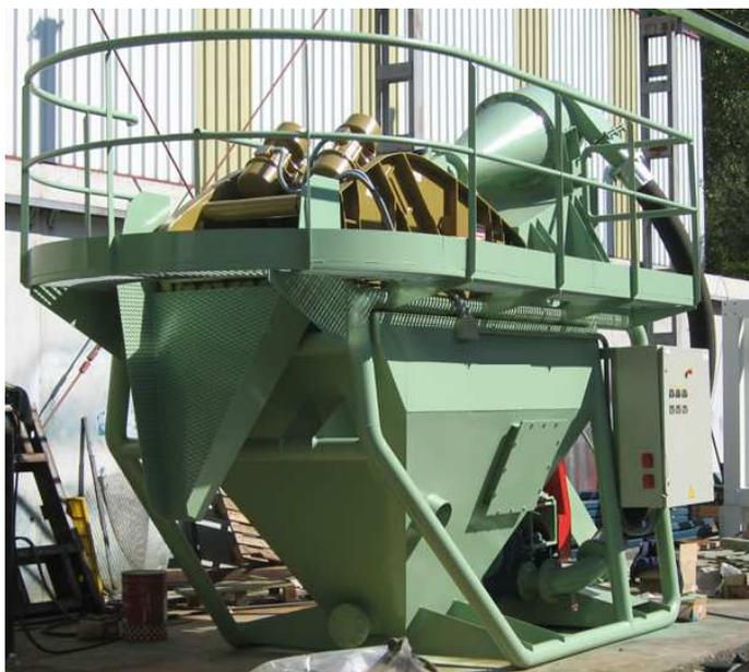
Os conjuntos compactos com peneiras desaguadora foram desenvolvidos, para lavar areia sem perda de fino e desaguar a areia na saída, ou seja, reduzir a umidade da areia na saída, com uma grande vantagem em relação às instalações tradicionais, o equipamento pode ser levado até a cava, onde é realizada a dragagem da areia.
